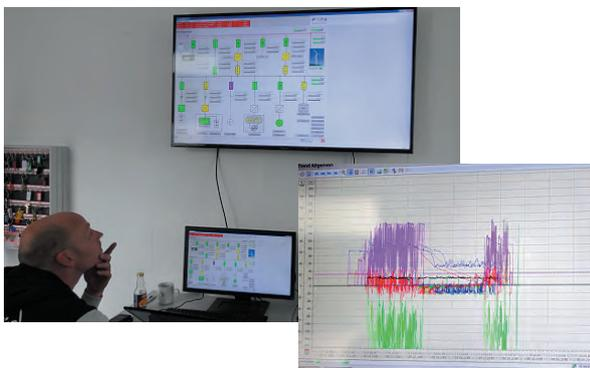
写真10 再生可能エネルギーによる発電量および負荷変動に対する水素燃料電池、蓄電池、キャパシタによる給電追随性を評価するシミュレーションシステムのモニター画面
