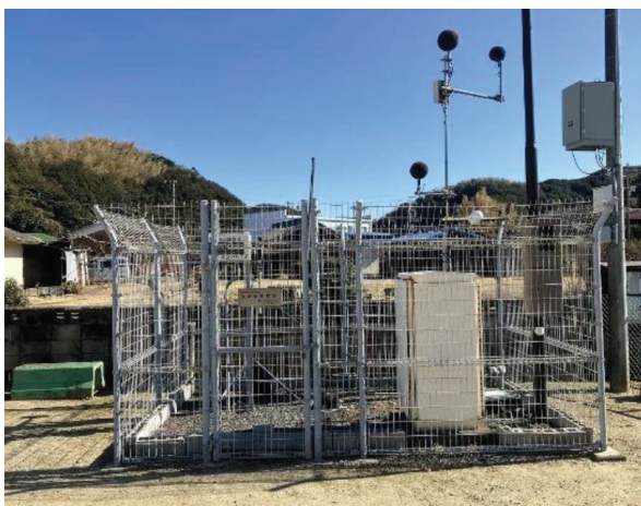
図6 航空機の低周波音の測定(美浜町内)
