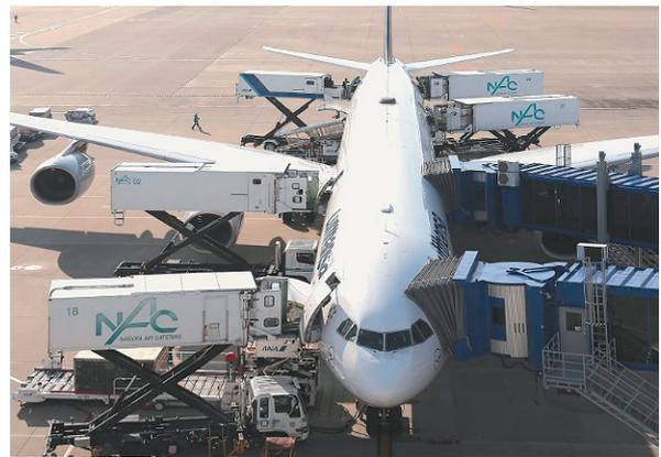
図表7 飛行機に横付けされたフードローダー
