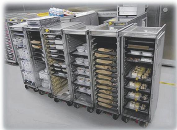
図表11 サービスカートの積み込み状況
